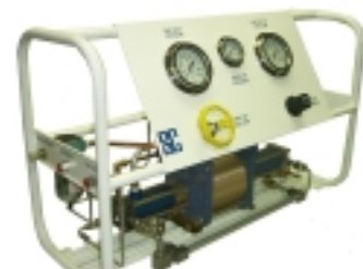
Reforzadores de gas Serie GBD & GBT 10:1 hasta 100:1, de doble acción, simple y doble accionamiento. Rango de presión hasta 1725 bar
